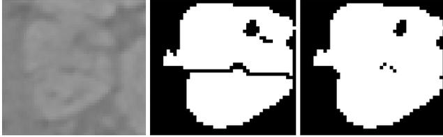
Abbildung 8. Links: Original Graustufenbild des Partikels; Mitte: Segmentierung mit Standard-Watershed-Algorithmus; Rechts: Zusammengeführtes Partikel [9].
