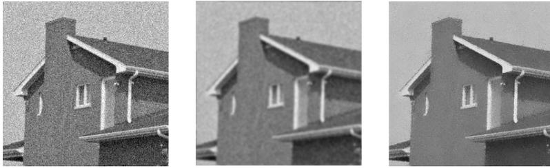
Abbildung 4: links: verrauschtes Bild; mitte: Binomialfilter; rechts: selektiver gaußscher Weichzeichner
