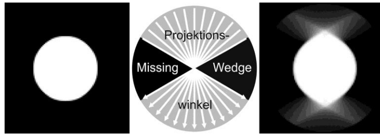
Bild 1. Missing-Wedge-Problematik; links: isotropes Modell; Mitte: Winkelverteilung für 120° Projektionssektor und 60° Missing Wedge; rechts: typische Elongationsartefakte der konventionellen gefilterte Rückprojektion (FBP)
